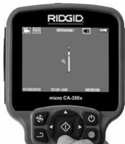
Рис. 15 - Настройка изменения масштаба изображения
