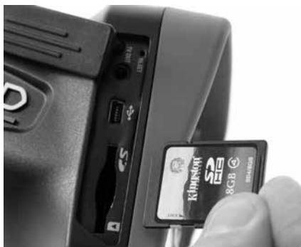
Slika 9 - Umetanje SD kartice
