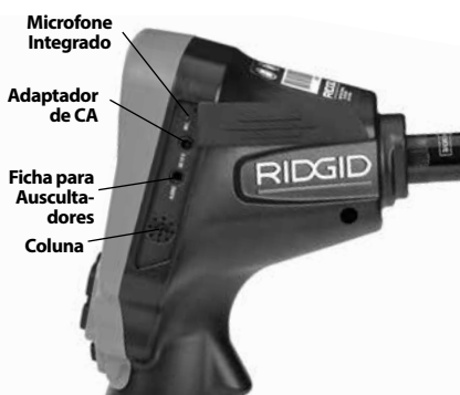
Figura 3 - Tampa da Porta Lateral Direita
