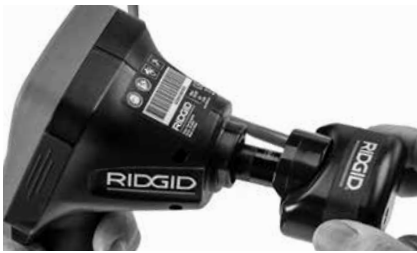
Εικόνα 18 - Βύσμα σύνδεσης κάμερας τοποθετημένο
