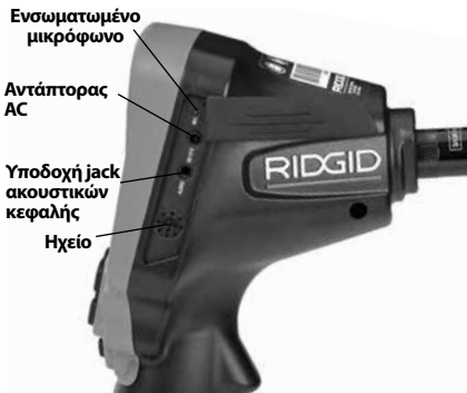
Εικόνα 3 - Κάλυμμα θύρας δεξιάς πλευράς
