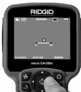
Figur 14 – Justering af lysdioder Zoom: micro CA-350x-inspektionskameraet har en 2,0 x digital zoom. Tryk blot på pilene op og ned ▲▼, mens du er i live-skærmen for at zoome ind eller ud. En indikatorbjælke for zoom vises på skærmen, når du justerer dit zoom.
