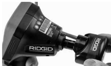
Obrázok č. 18 - Zasunutie konektoru kamery
