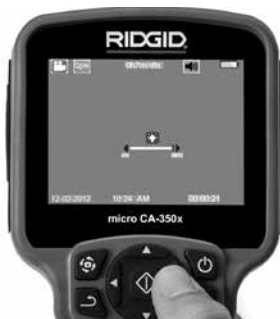
Figura 14 - Ajustar o LED
