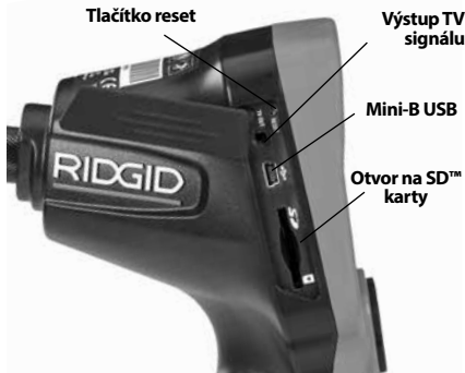
Obrázek 4 – Kryt vstupů na levé straně
