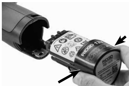
Obrázek 5 – Vyjmutí a instalace baterie
