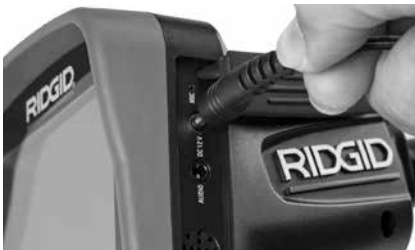
Εικόνα 6 – Τροφοδοσία της μονάδας με αντάπτορα AC
