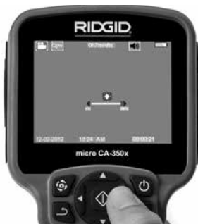
14. ábra – LED beállítása
