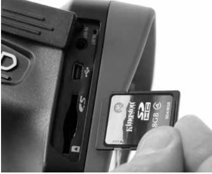
Şekil 9 - SD Kartın Takılması
