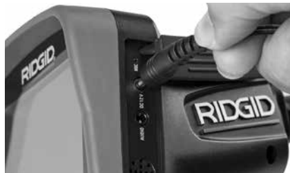
Figura 6 - Ligar a Unidade com Adaptador de CA
