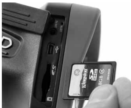
Slika 9 - Umetanje SD kartice
