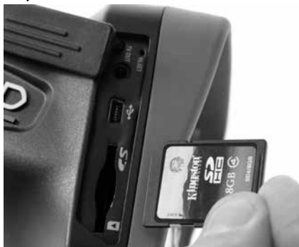
Rys. 9 - Wkładanie karty pamięci SD
