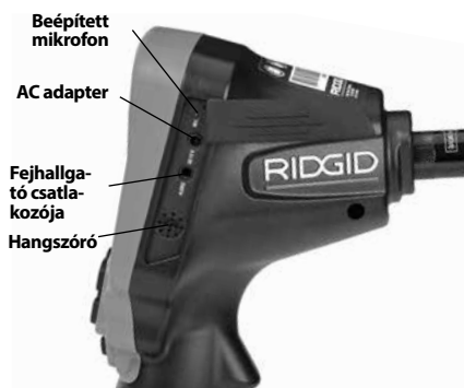
3. ábra – Jobb oldali csatlakozó-burkolat
