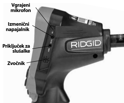
Slika 3 – Pokrov priključkov na desni strani
