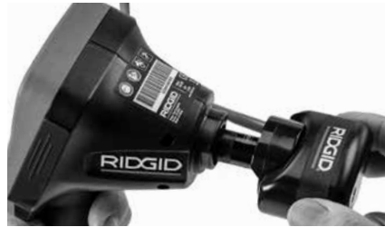
Figur 18 – Kamerans anslutningskontakt ansluten
