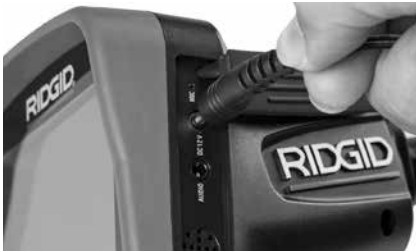
Abbildung 6 – Betreiben des Gerätes mit Netzteil
