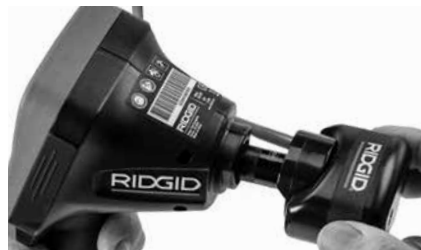
Obrázek 18 – Připojený konektor kamery
