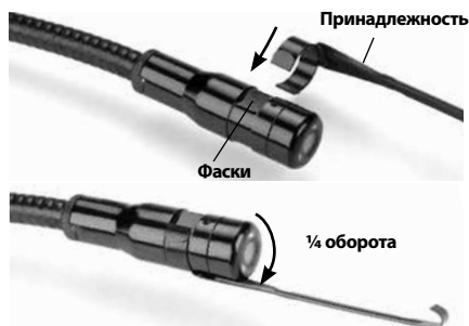
Рис. 8 - Установка принадлежности
