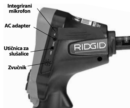
Slika 3 - Poklopac priključaka s desne strane
