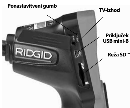
Slika 4 – Pokrov priključkov na levi strani
