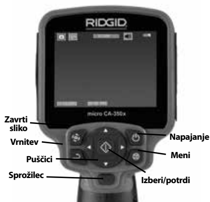
Slika 2 – Elementi za upravljanje
