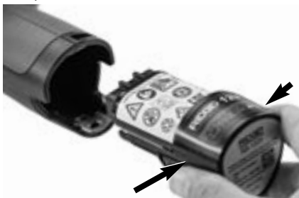
Figura 5 – Extracción e instalación de la batería
