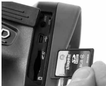
9. ábra – SD-kártya behelyezése
