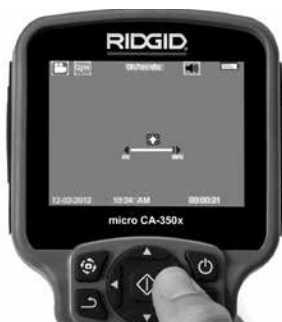
Slika 14 – Nastavljanje lučke LED
