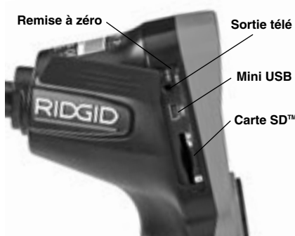
Figure 4 – Branchements côté gauche
