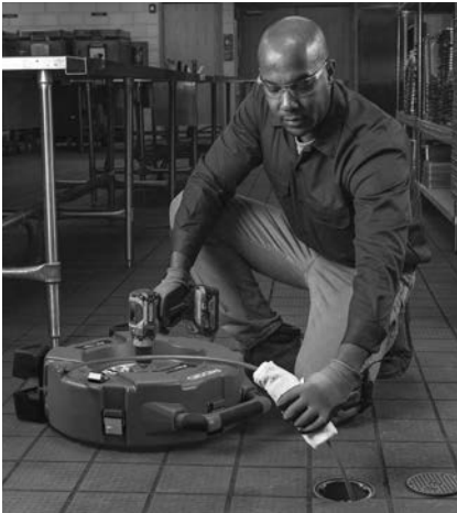
Figura 13 – Aplicar lubrificante ao revestimento do cabo
