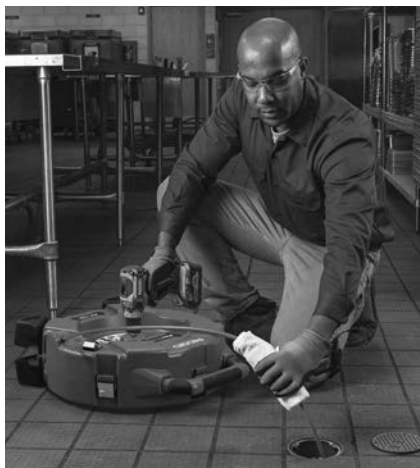
Εικόνα 13 – Εφαρμογή λιπαντικού στο περίβλημα σπιράλ
