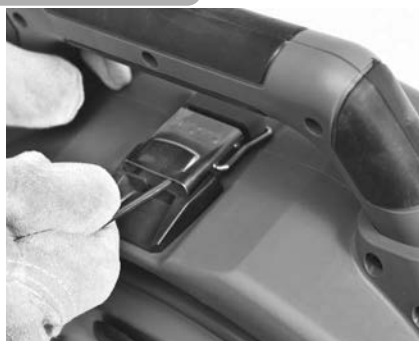
Slika 14 – Odprite zapahe pod ročajem za nošenje (uporabite šestkotni ključ)
