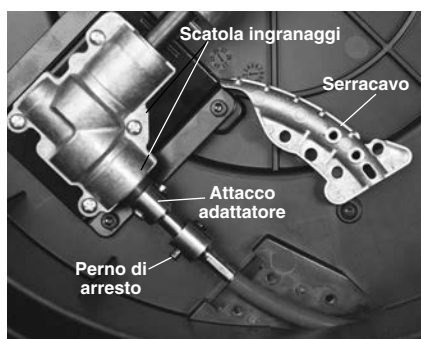
Figura 15 – Alloggiamento della stasatrice aperto
