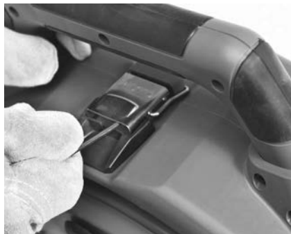
Slika 14 – Otvoravanje zasuna ispod ručke za nošenje (s pomoću šesterokutnog ključa)
