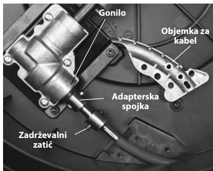
Slika 15 – Odprto ohišje naprave za čiščenje odtokov
