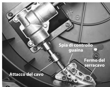
Figura 16 – Sostituzione del Gruppo del cavo
