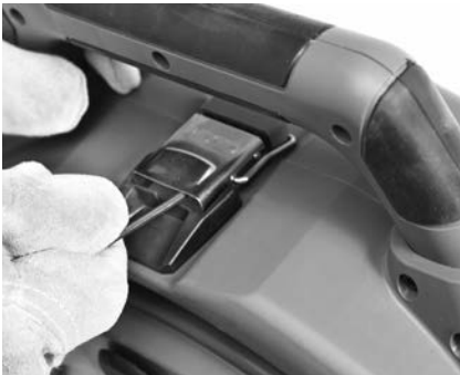
Abbildung 14 – Verschluss unter dem Tragegriff öffnen (mit Sechskantschlüssel)
