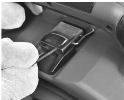
Obrázok 14 – Otvorenie západky pod držadlom (pomocou šesťhranného kľúča)
