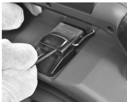
Figur 14 - Åpne låsen under bærehåndtaket (bruk sekskantnøkkel)
