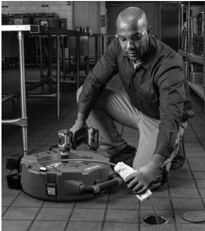
Abbildung 13 – Auftragen von Schmiermittel auf die Spiraleummantelung
