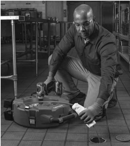
Slika 13 – Nanošenje maziva na izolaciju sajle
