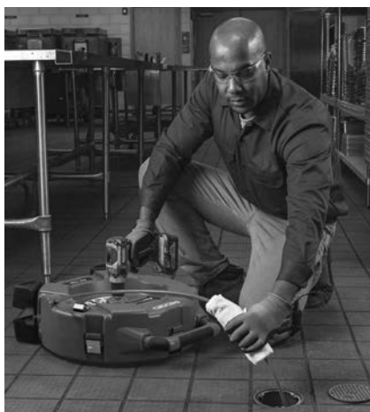
Slika 13 - Nanašanje maziva na ovoj kabla
