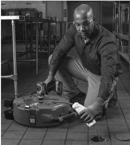
Figura 13 – Applicazioni di lubrificante nella Guaina del cavo
