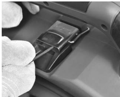
14-сурет — Тасу тұтқасының астындағы ілгішті ашу (алты қырлы кілтті пайдаланыңыз)
