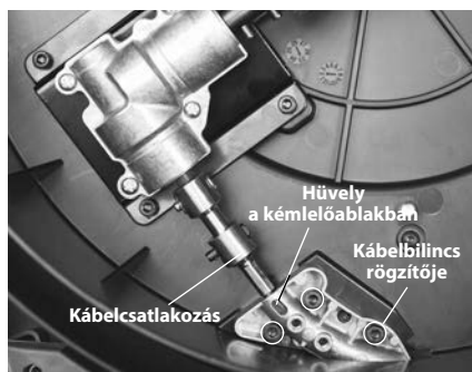
16. Ábra – A kábelszerelvény cseréje
