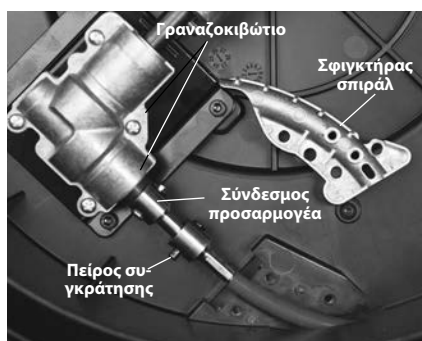
Εικόνα 15 – Ανοιγμένο περίβλημα μηχανήματος απόφραξης αποχετεύσεων
