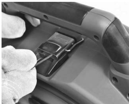
Slika 14 - Otvorite zasun ispod ručke za nošenje (koristite imbus ključ)
