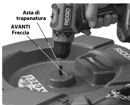
Figura 4 – Collegamento del trapano all'asta di trapanatura
