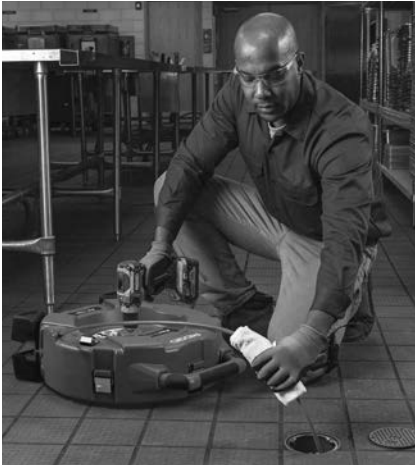
Figur 13 – Applicera smörjmedel på spiralhöljet
