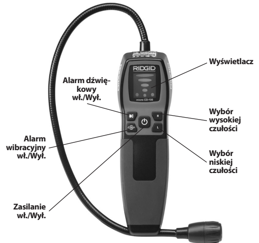
Rysunek 2 – Części micro CD-100
