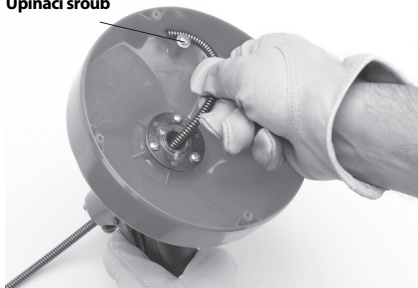
Obrázek 9 – Instalace konce kabelu do držáku
