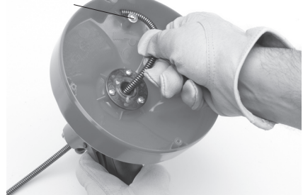
Şekil 9 - Kablunun Ucunun Tutucuya Takılması
