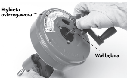
Rysunek 2 – Zdejmowanie korby z narzędzia Power-Spin
