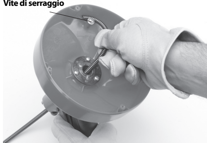
Figura 9 – Installazione dell'Estremità del cavo nel Supporto
