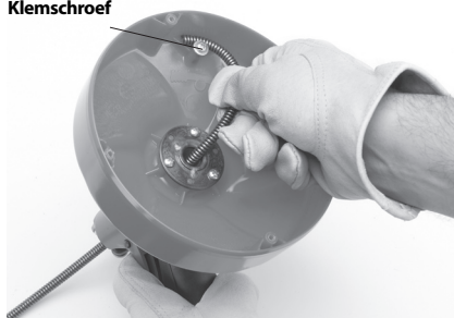
Figuur 9 – Veeruiteinde in de houder bevestigen
