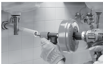
Obrázok č. 7 – Príklad predĺženia odtoku do vzdialenosti 4" (100 cm) od otvoru bubna
