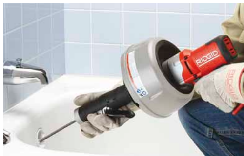
Model K-45AF szybko udrażnia zatkane linie wannowe. Posuw i wycofywanie sprężyny bez zmiany kierunku pracy silnika.
