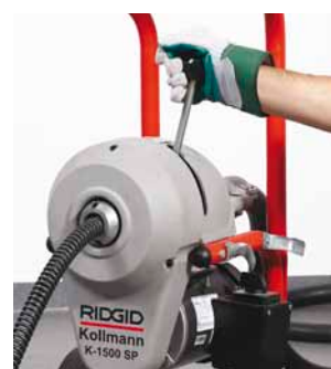
Po zwolnieniu uchwytu sprężyna natychmiast się zatrzymuje
