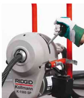
Po załączeniu sprzęgła sprężyna obraca się
