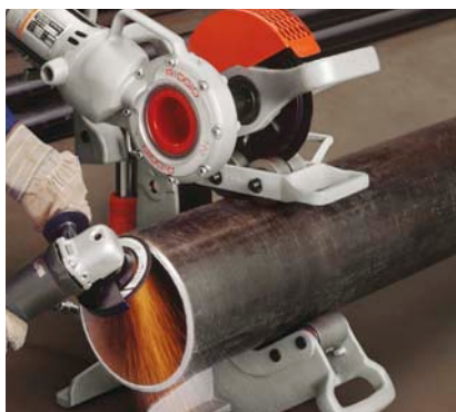
Model 258 z rolką do ukosowania rur w użyciu. Zaleca się wykonywanie tej operacji przez dwie osoby
